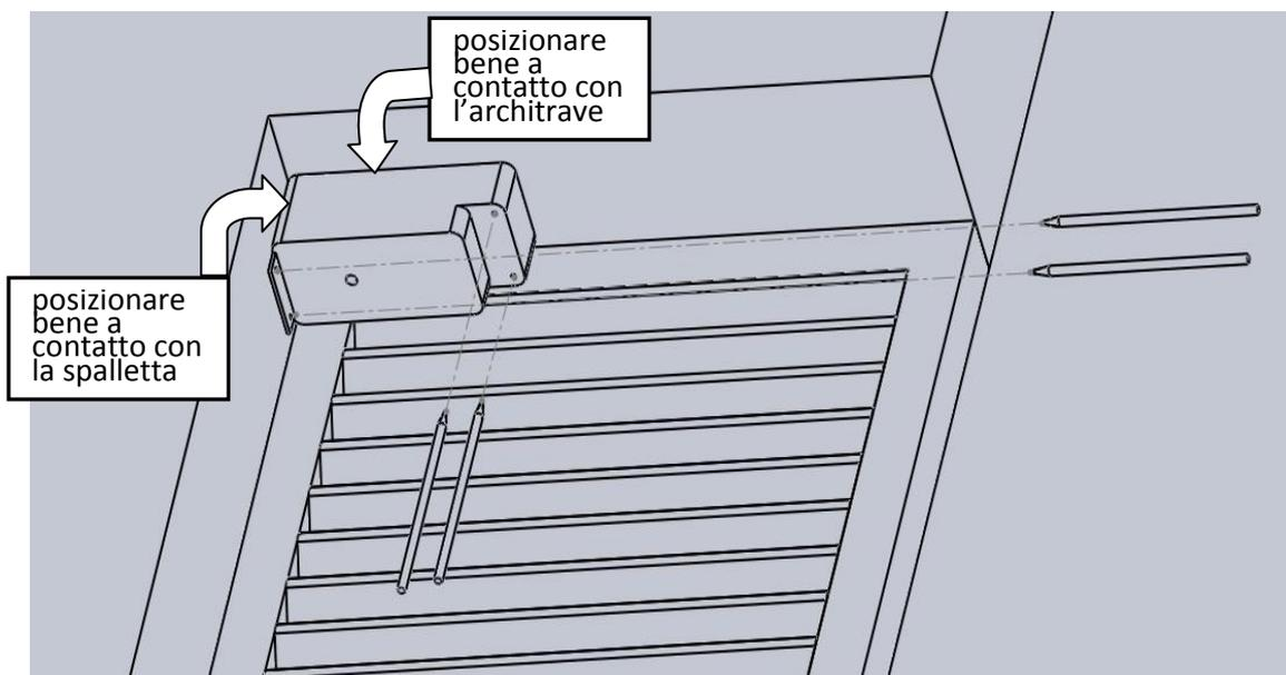
4) posizionare l'attuatore appoggiandolo alla persiana ed ai montanti (architrave e spalletta) dell'apertura della finestra e segnare le posizioni dei 4 fori da eseguire per fissare l'attuatore
